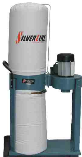
Colector de Aserrín de 1 H.P.
