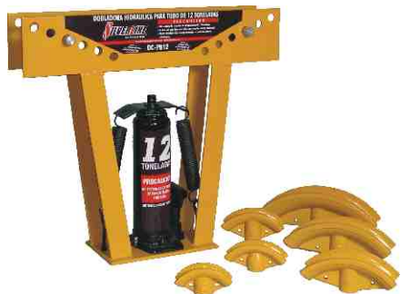
Dobladora de Tubo Hidráulica de 12 Toneladas Para tubo de 1/2", 3/4", 1", 1-1/4", 1-1/2", 2". Ángulo máximo 30°
